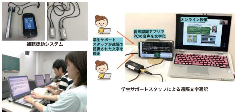
補聴援助システム 音声認識アプリでPCの音声を文字化 学生サポートスタッフが遠隔で認識された文字を修正 学生サポートスタッフによる遠隔文字通訳 学生サポートスタッフによるパソコンテイク
